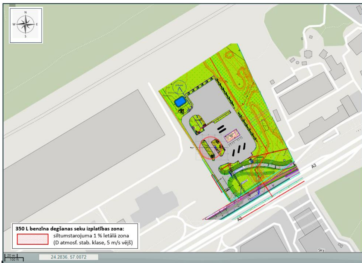
4.3. att. Siltumstarojuma izplatības zona 350 L noplūduša benzīna gadījumā (ar degšanu)
