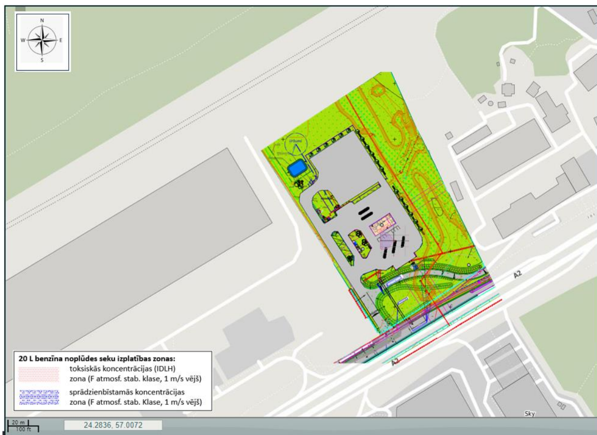
4.1. att. Toksiskās un sprādzienbīstamās koncentrācijas izplatības zonas 20 L noplūduša benzīna gadījumā (bez degšanas)
