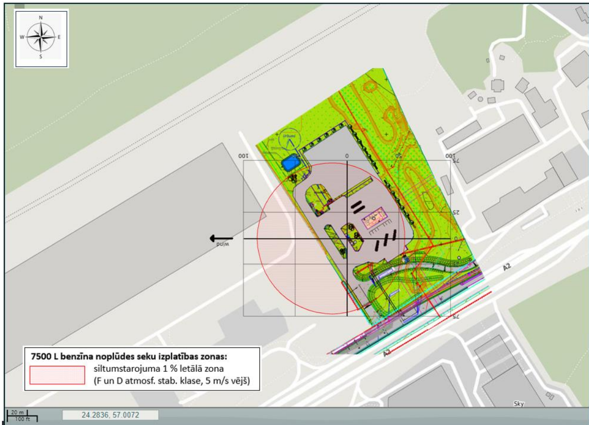
4.5. att. Siltumstarojuma izplatības zona 7500 L noplūduša benzīna gadījumā (ar degšanu)
