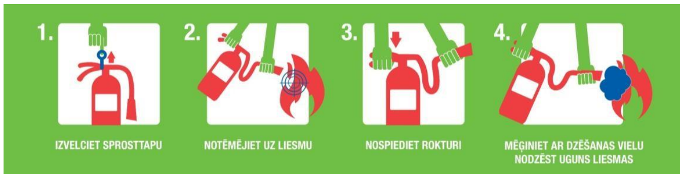
14.attēls. Pulvera ugunsdzēsības aparāta lietošanas pamācība
