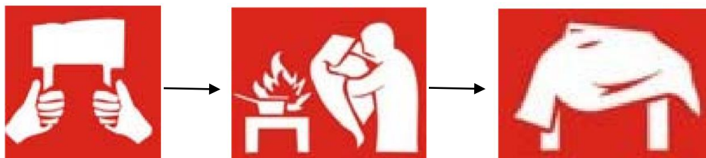
17.attēls. Ugunsdzēsības pārklāja lietošanas pamācība dzēšot degošu virsmu
