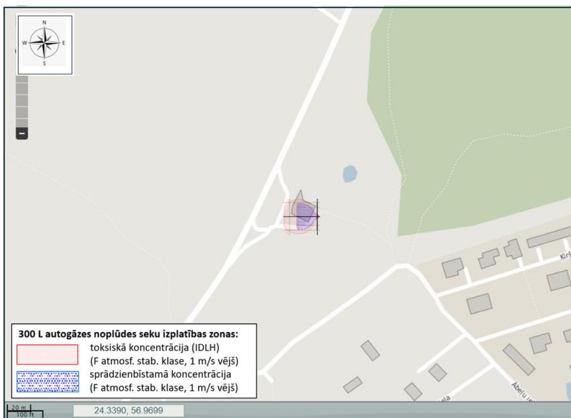
4.6. att. Toksiskās un sprādzienbīstamās koncentrācijas izplatības zonas 300 L noplūdušas autogāzes gadījumā (bez degšanas)
