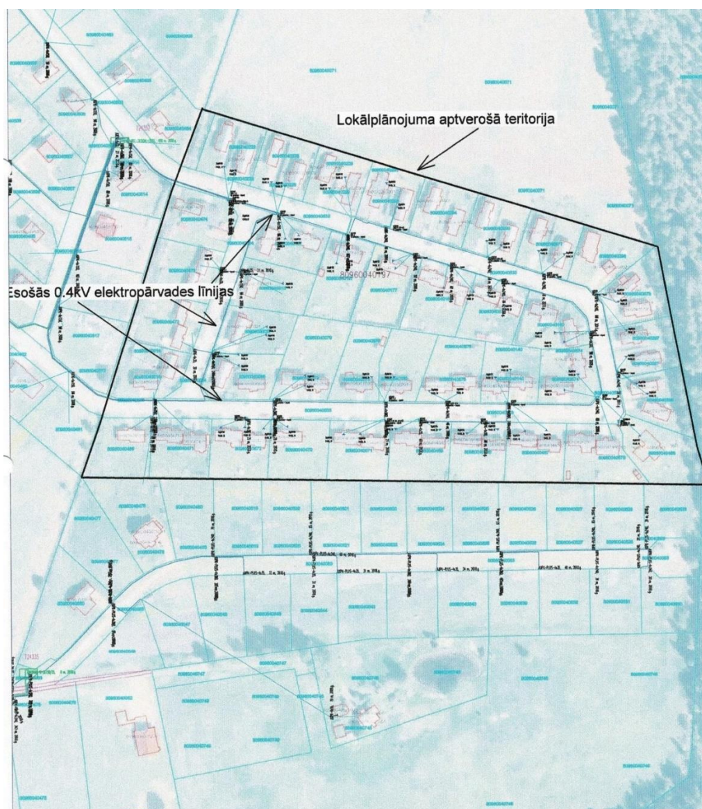
20.attēls. Lokālplānojuma teritorijā esošā elektroapgādes shēma. 9
